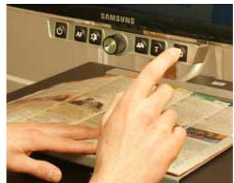
*Über das Bedienfeld mit sechs Funktionstasten und Drehregler passen Sie die Darstellung an.*
